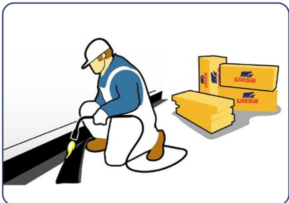
Desky si připravíme k aplikačnímu místu. Izolaci URSA XPS aplikujeme po dokončení hydroizolačních prací (hořáky určené k aplikaci hydroizolačních vrstev nesmí přijít do přímého kontaktu s URSA XPS).
