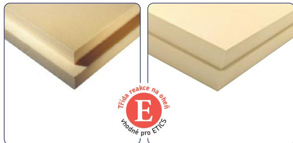
Tuhá tepelně izolační deska na bázi extrudovaného polystyrenu s hladkým povrchem. Maximální tepelný výkon doplněný vysokou pevností v tlaku s velmi nízkou nasákavostí. Hrana desky polodrážka, žlutá barva. Pěnidlo CO<sub>2</sub>, plyn v buňkách – vzduch.
