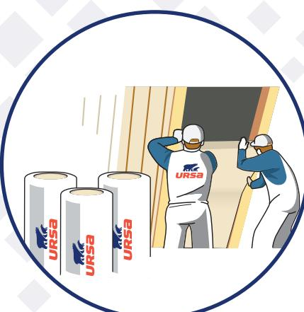
Aplikace minerální izolace URSA PUREONE USF 31 mezi krovky. Izolaci mezi krovky postupně vkládáme lehkým vtlačením po obou stranách její výšky, až zaplníme celé krovkové pole. K zajištění izolace v krovkovém poli je vhodné při aplikaci použít fixační prvky.
