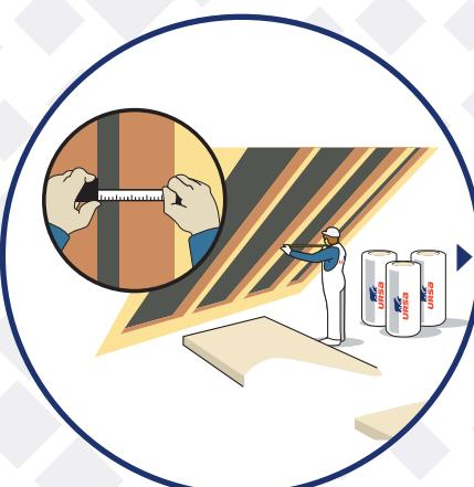
Změříme si šířku rozteče krovků. Pro zajištění lepší fixace minerální izolace URSA PUREONE USF 31 mezi krovkami přidáme k naměřenému rozměru ještě 1cm.
