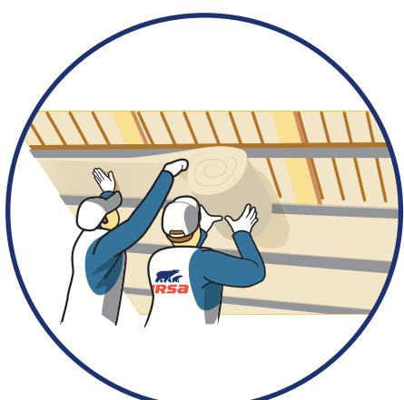
Aplikace minerální izolace URSA PUREONE USF 31 do příčného kovového roštu upevněného na krovky, jako druhá tepelně izolační vrstva. Izolaci vkládáme lehkým vtlačením po celé délce roštu. Dbejte stejných zásad jako v předešlém aplikačním kroku.
