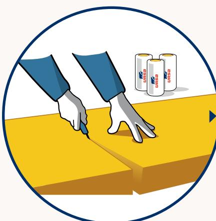
Odřízneme naměřenou část minerální izolace URSA DF 32H. Řez provádíme podél přitlačné lišty (část OSB desky, kovový profil apod.) speciálním nožem URSA určeným k rezání izolace.
