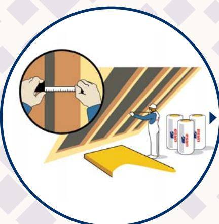
Změříme si šířku rozteče krovkí. Pro zajištění lepší fixace minerální izolace URSA DF 32H mezi krovkami přidáme k naměřenému rozmezru ještě 1,5–2 cm.
