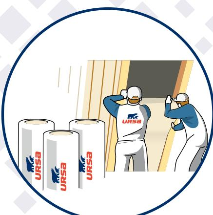
Aplikácia minerálnej izolácie URSA PUREONE SF 34 medzi krovky. Izoláciu medzi krovky postupne vkladáme ľahkým vtlačením po oboch stranách jej výšky, až zaplníme celé krovkové pole. Na zabezpečenie izolácie v krovkovom poli pri aplikácii použijeme fixačné prvky napr. drôtovanie.
