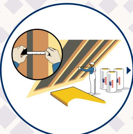
Změříme si šířku rozteče krovkí. Pro zajištění lepší fixace minerální izolace URSA SF 32 PLUS mezi krovkami přidáme k naměřenému rozměru ještě 1 cm.
