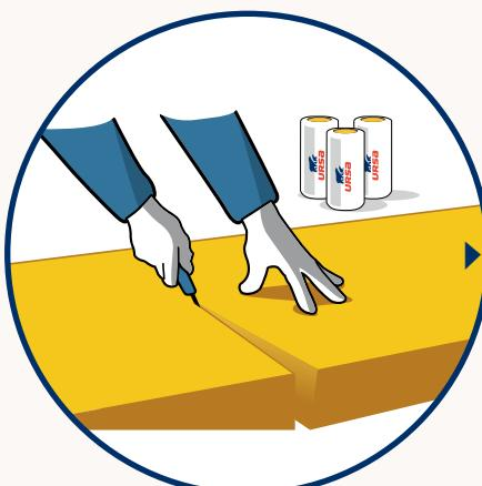
Odřízneme naměřenou část minerální izolace URSA SF 32 PLUS. Řez provádíme podél přitlačné lišty (část OSB desky, kovový profil apod.) speciálním nožem URSA určeným k rezání izolace.
