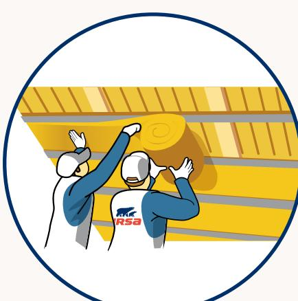
Aplikace minerální izolace URSA USF 35 PLUS do příčného kovového roštu upevněného na krovky, jako druhá tepelně izolační vrstva. Izolaci vkládáme lehkým vtlačením po celé délce roštu. Dbejte stejných zásad jako v předešlém aplikačním kroku.
