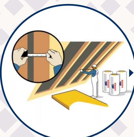
Změříme si šířku rozteče krovků. Pro zajištění lepší fixace minerální izolace URSA USF 35 PLUS mezi krovkami přidáme k naměřenému rozměru ještě 1,5–2 cm.
